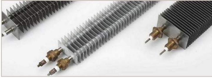
Las resistencias eléctricas de aletas se utilizan para el calentamiento de aire y otros gases. Están formadas por elementos tubulares blindados a los que se les añade unas aletas para aumentar así la superficie de intercambio de calor.
